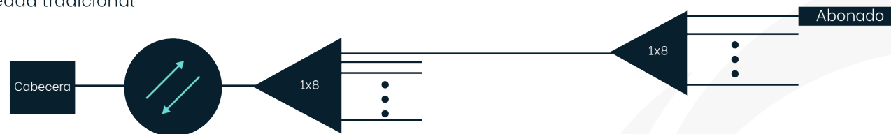
Arquitectura PON Desbalanceada Preconectorizada
